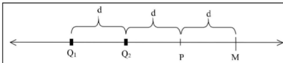
Qual é o módulo de uma terceira carga pontual  $Q_3$ , a ser fixada no ponto P de modo que o campo elétrico resultante da interação das 3 cargas no ponto M seja nulo?
